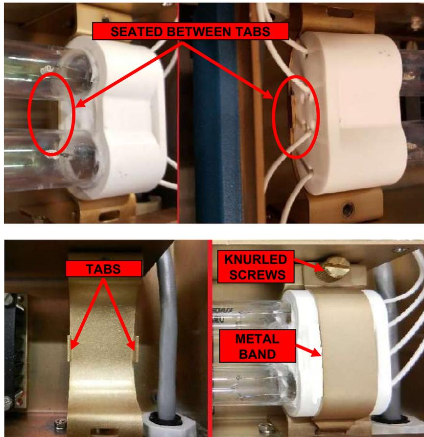
**Figure 1 – SECURE LAMP INSIDE THE LAMP BOX**
