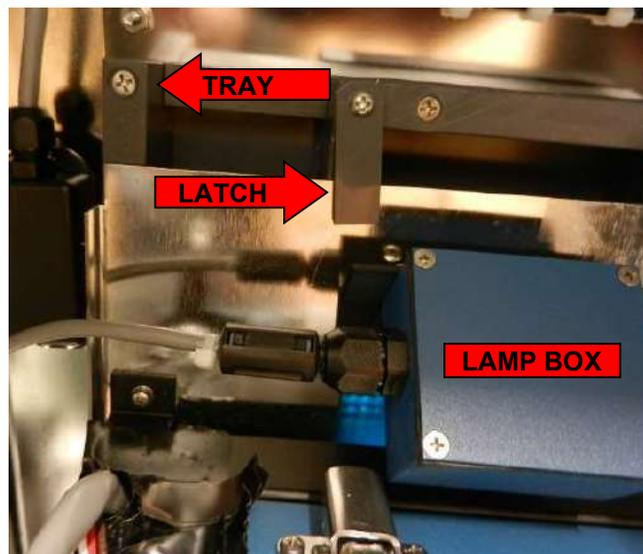
**Figure 3 – BLUE LAMP BOX SECURE AGAINST TRAY**
